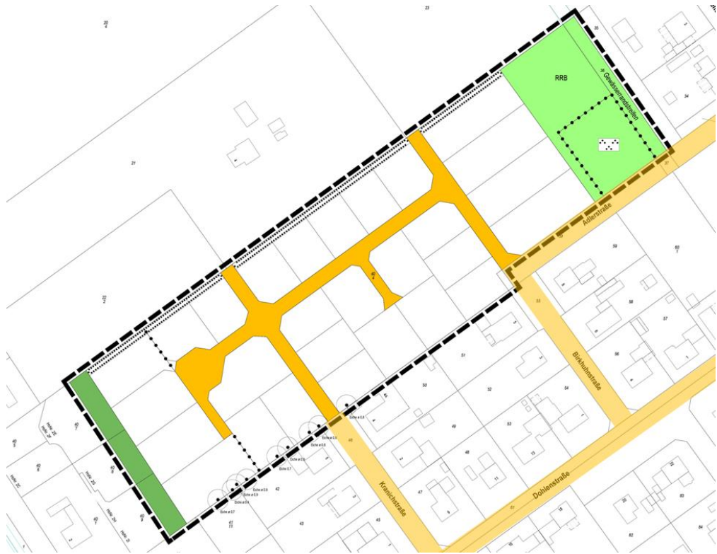
Abb. 8 Interne Erschließung mit umliegender Straßenanbindung
