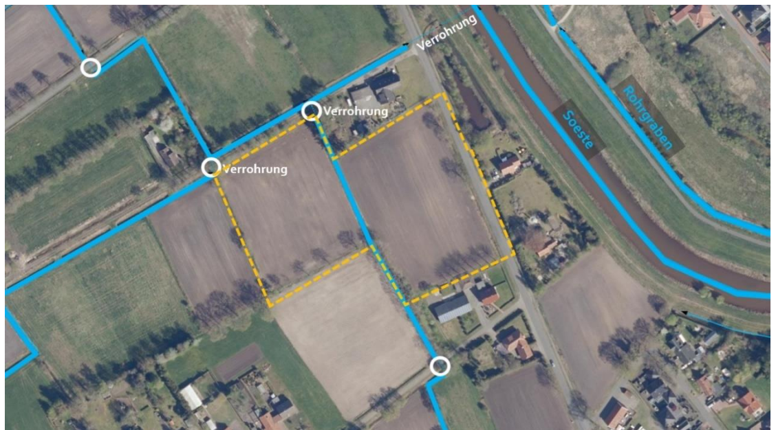
Abb. 11 Übersicht der Gewässer im Plangebiet und der Umgebung
