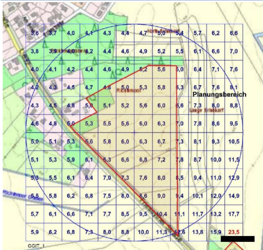
Abb. 13 Darstellung der von den vorhandenen und geplanten Tierhaltungen induzierten Geruchsstundenhäufigkeiten als Flächenwerte, Raster 25x25 m
