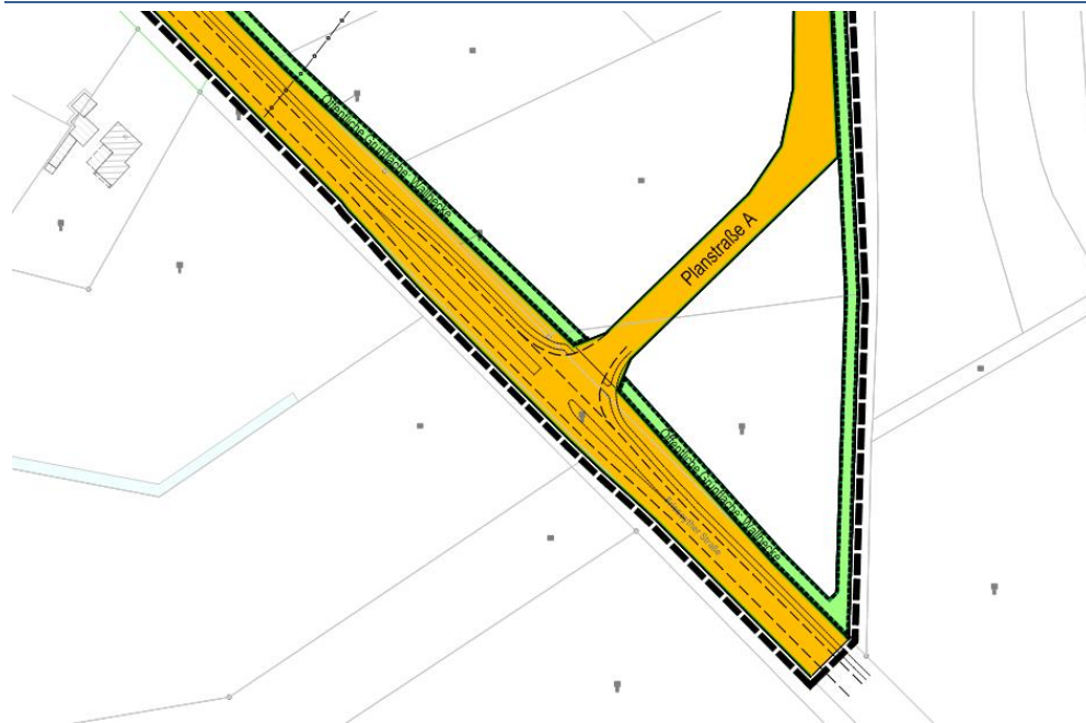
Abb. 10 Aufweitung der Friesoyther Straße zur Herstellung einer Abbiegespur
