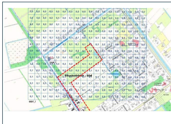
Abb 5 Darstellung der von den vorhandenen und geplanten Tierhaltungen induzierten Geruchsstundenhäufigkeiten als Flächenwerte, Raster 25x25 m
